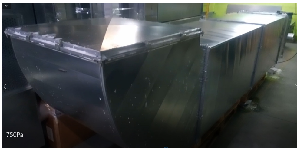
Príloha č. 1 – Foto skúšanej potrubnej trasy
